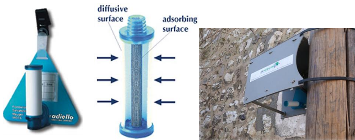
Figure 3 : Support, tube passif Radiello® et boîte de protection
