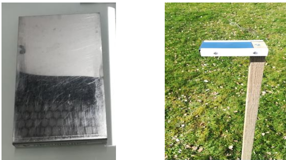
Figure 4 : Plaquette de dépôt et support
